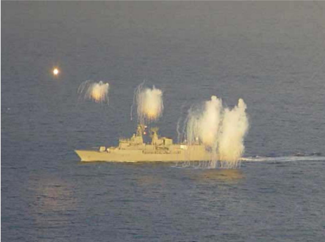
*Flare multispettrali (hot-cold flare):* mantengono il livello totale di energia prodotta distribuendolo, nel periodo di tempo, secondo un profilo di combustione diverso e simile a quello del velivolo, ingannando così i sensori bicolori. Già impiegate in azione (Iraq), hanno dato risultati controversi.
