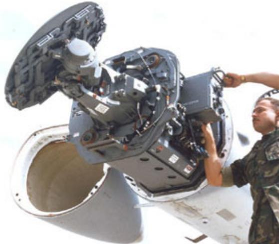
Per l' F/A-18, il piccolo radar del YF-17 è stato sostituito con uno più potente, che avrebbe dovuto lavorare con missili BVR.
