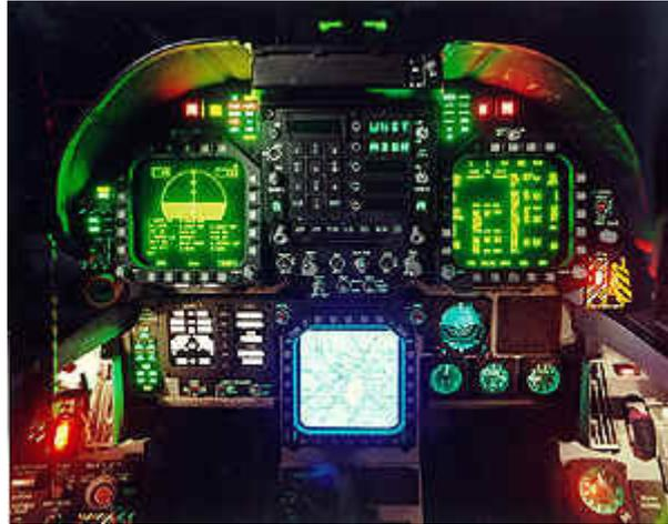
Le informazioni provenienti al radar APG-63 vengono elaborate sottoforma digitale dal computer centrale IBM CP-1075. Le informazioni vengono successivamente visualizzate al pilota per mezzo del *Honeywell Vertical Situation Display* o sul *AVQ-20 Heads-Up Display (HUD)*.
