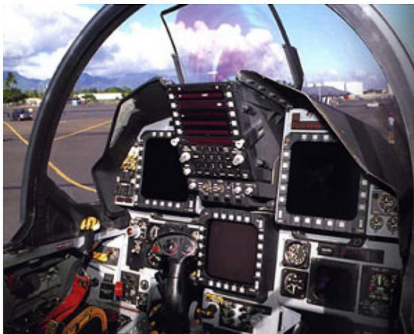
Il cuore tecnologico dell' F-15 è rappresentato dal suo impianto avionico comprendente il potente radar a impulsi Doppler Hughes AN/APG-63 X-band (8-12 GHz) con capacità look-down, shoot-down con *range* di rilevamento di oltre 100 miglia.
